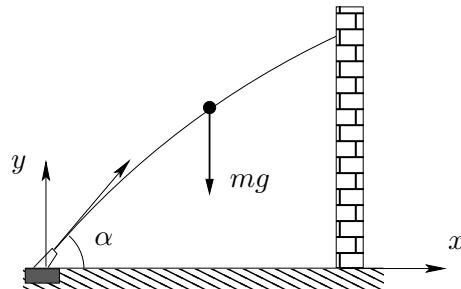
Om begynnelsehastigheten betecknas  $v_0$  fås efter integration och användning av begynnelsevillkoren  $\dot{x} = v_0 \cos \alpha$  och  $\dot{y} = v_0 \sin \alpha$  för  $t = 0$
