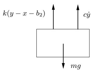
Övre fjäderns längd är  $2x - L$ , där  $L$  är linans längd. Fjäderkraften är då  $2k(2x - L - b_1)$ , där  $b_1$  är fjäderns ospända längd. Den undre fjädern har längden  $y - x$  och fjäderkraften  $k(y - x - b_2)$ , där  $b_2$  är den naturliga längden. Trissan:
