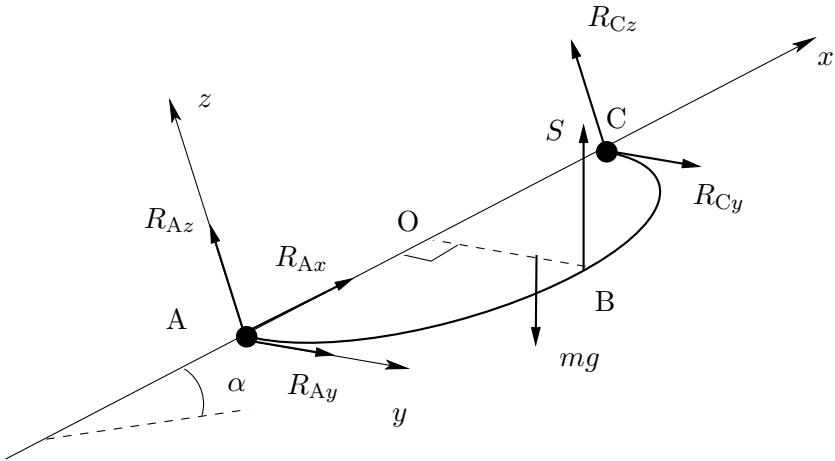
Inför ett koordinatsystem med  $x$ -axeln längs AC och  $y$ -axeln horisontell. Linkraften och tyngdkraften bildar då vinkeln  $\alpha$  med  $z$ -axeln. Beteckna radien med  $R$ .
