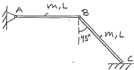
En struktur i jämvikt är sammansatt av två stänger, AB och BC, med massa  $m$  och längd  $L$  vardera. Stängerna är friktionsfritt ledade i A och B. Ena stängen stöder mot det sträva underlaget i C.
