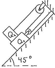
Två sträva kroppar med tyngden  $Q_1$  och  $Q_2$  är förenade med linor enligt figur. Bestäm största och minsta värdet på kvoten  $Q_1/Q_2$  som kan förekomma vid jämvikt. Friktionskoefficienten är 0.3 mellan kropparna samt mellan undre kroppen och underlaget. (5 poäng)
