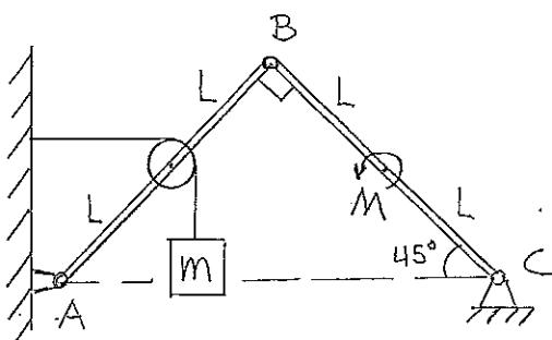
En struktur är sammansatt av två masslösa stänger, AB och BC. Mitt på stång AB är en masslös trissa fäst. En lina löper över trissan, där ena linänden uppbär en massa  $m$  enligt figur. Mitt på stång BC verkar ett rent moment  $M$ . Stängerna är friktionsfritt ledade i A, B, C.
