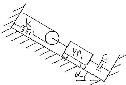
En massa  $m$  är forbunden med en dämppare, dämpningskonstant  $c$ , och en fjäder, fjäderkonstant  $k$ , enligt figuren. Systemet är kritiskt dämppat och släpps från vila vid  $t = 0$  då fjädern är ospänd. Bestäm
