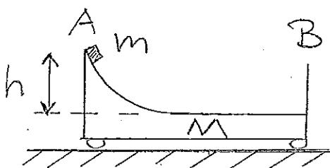
En partikel, massa  $m$ , är placerad på en vagn, massa  $M$ . Partikeln släpps från vila vid A (höjden  $h$ ) och glider mot vagnens främre ände B. All friktion kan försummas. Bestäm
