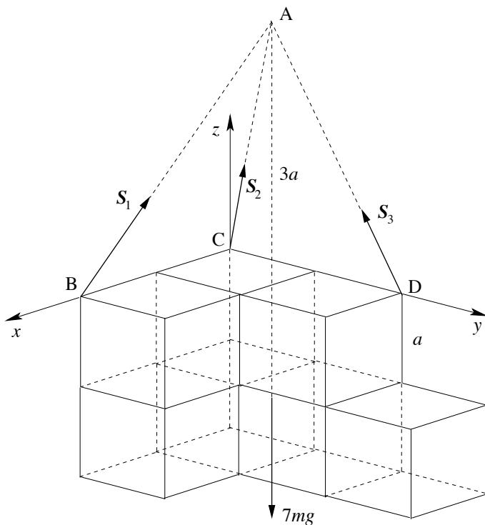
Kroppen påverkas av tre linkrafter och tyngdkraften. Verkningslinjerna för linkrafterna går alla genom A. Vid jämvikt är momentsumman med avseende på A noll. Detta betyder att även tyngdkraftens verkningslinje måste gå genom A, d v s tyngdpunkten ligger rakt under A.
