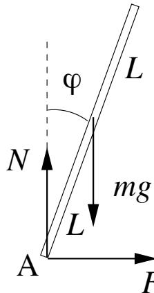
Så länge inte stången glider i kontaktpunkten A, roterar den kring en fix axel.
