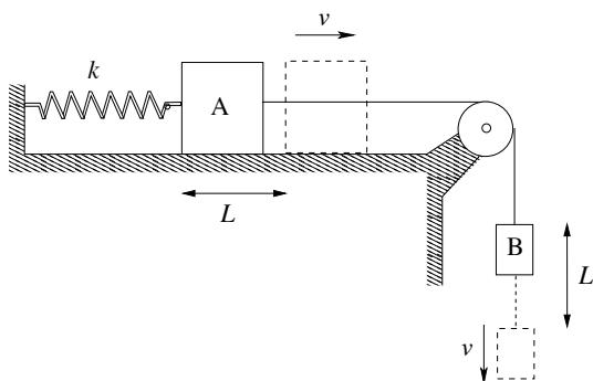
De enda krafter som uträttar arbete är tyngdkraften på B och fjäderkraften. Eftersom dessa är konservativa, bevaras den mekaniska energin, d v s
