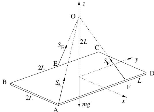
Eftersom samtliga linkrafters verkningslinjer går genom O, och momentsumman med avseende på O är noll, så måste även tyngdkraftens verkningslinje gå genom O, d v s tyngdpunkten ligger rakt under O.
