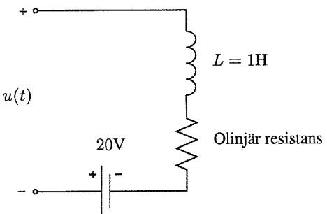
Figuren visar en elektrisk krets med en olinjär resistans, en induktans, en konstant spänningsskälla, samt en tidsvariabel insignalspänning  $u(t)$ .
