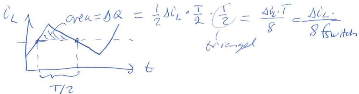
Spanningsrippel pga upp- & nerlädning  $\Delta U_{ut} = \Delta U_C = \frac{\Delta Q}{C}$
