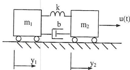
Härled en linjär tillståndsmodell för ”tåget” (lok och en vagn) i figuren ovan. D v s välj tillståndstorheter och bestäm matriserna ”ABCD”. Insignalen är lokets dragkraft  $u(t)$  och utsignalen är vagnens position  $y_1$ . Antag att fjädrarna har sin naturliga längd då  $y_1=y_2=0$ . **3p**
