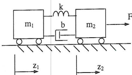
Härled en linjär tillståndsmodell för "tåget" (lok och en vagn) i figuren ovan. D v s välj tillståndsstorheter och bestäm matriserna "ABCD". Insignalen är lokets dragkraft  $F$  och utsignalen är vagnens position  $z_1$ . Antag att fjädern har sin naturliga längd då  $z_1=z_2=0$ . **4p**
