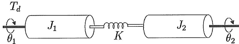
Insignalen till systemet är det drivande momentet  $T_d(t)$ .  $\theta_1(t)$  och  $\theta_2(t)$  anger vinkelns för vänster respektive höger axelhalva.  $\omega_1(t) = \dot{\theta}_1(t)$  och  $\omega_2(t) = \dot{\theta}_2(t)$  är vinkelhastigheten för vänster resp. höger axelhalva. Axeln innehåller ett vekt parti i mitten som kan betraktas som en torsionsfjäder med fjäderkonstanten  $K > 0$ . Tröghetsmomenten för de två axelhalvorna är  $J_1$  respektive  $J_2$ . Friktionen är försumbar.
