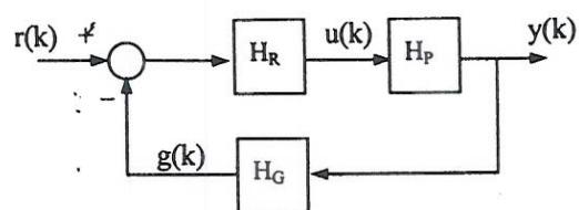
En tidsdiskret, proportionell regulator med överföringsfunktion  $H_R(z) = K$ , där  $K > 0$ , ska användas som regulator i reglersystemet. Bestäm hur stort  $K$  maximalt får vara om reglersystemet ska vara stabilt. (2 p)
