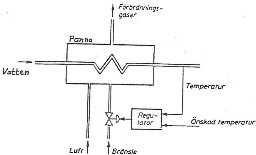
Man vill reglera en uppvärmningsanläggning för vatten enligt figuren ovan. Avsikten är att styra bränsletillförseln så att temperaturen på det uppvärmda vattnet hålls konstant. Genom stegexperiment har man funnit att en användbar modell för processen med tillhörande bränsleventil och temperaturgivare har överföringsfunktionen:
