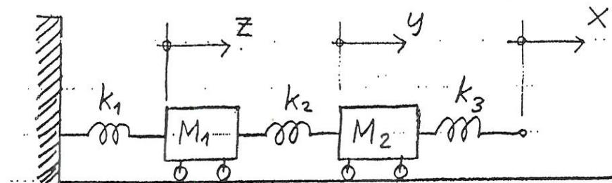
Rullningsfriktionen mot golvet är försumbar. De båda massornas positioner betecknas med  $y$  och  $z$ . Positionen för fästpunkten på den yttre fjädern betecknas med  $x$ .
