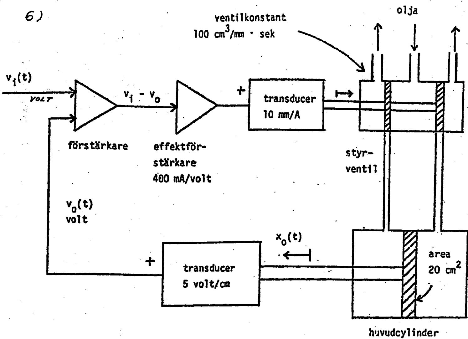
Figuren föreställer ett hydrauliskt system med återföring. Pilen i anslutning till en transducer (omvandlare) innebär att en rörelse i pilens riktning ger en positiv utsignal respektive orsakas av en positiv insignal.
