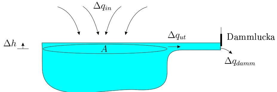
Inflödet till sjön är  $\Delta q_{in}$  och utflödet från sjön är  $\Delta q_{ut}$ . Eftersom det tar tid innan en ändring i  $\Delta q_{damm}$  ger utslag i  $\Delta q_{ut}$  har vi
