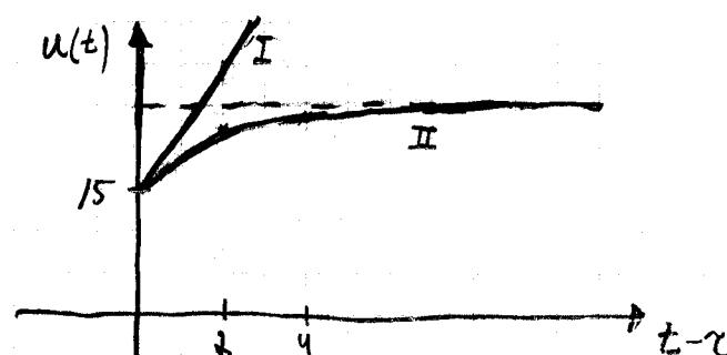
I fall I integreras styrsignalen upp, medan stursignalen är begränsad i fall II. Om r(t) återgår till siffran 0, säger vi att integrera bort i fall I.
