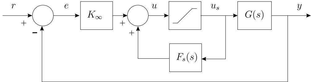
Denna realisering ger ett väl fungerande system då överföringsfunktionen  $F_s(s)$  är *stabil* och konstanten  $K_\infty$  väljs lika med regulatorns högfrekvensförstärkning, d.v.s.  $K_\infty = F(\infty)$ .
