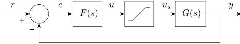
Då styrsignalen hamnar i begränsningsläget upphör återkopplingen temporärt att fungera, eftersom styrsignalen till processen  $u_s(t)$  då är konstant (lika med  $u_{min}$  eller  $u_{max}$ ). Detta leder till problem då regulatorn i sig är instabil, vilket gäller exempelvis i det vanligt förekommande fallet att regulatorn  $F(s)$  är en PI-regulator. Ett sätt att råda bot på detta problem visas i följande blockschema, där den begränsade styrsignalen  $u_s$  återkopplas via positiv återkoppling.
