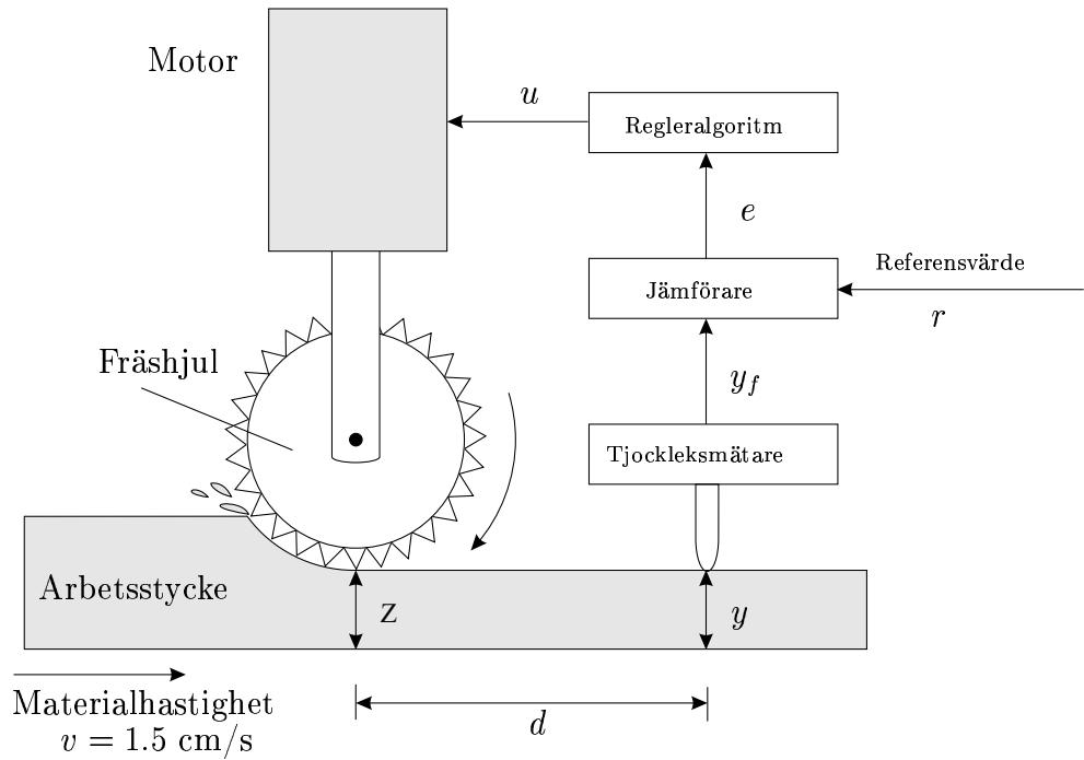
Figuren ovan visar en fräs med automatisk reglering av fräsdjupet. Arbetsstyckets hastighet i förhållande till fräshjulet är  $v = 1.5 \text{ cm/s}$ . Fräshjulet höjs och sänks med motorn enligt figur. Tjockleken  $y$  mäts med en givare placerad  $d$  meter från hjulet. Givaren antas vara av lågpasskaraktär med följande överföringsfunktion
