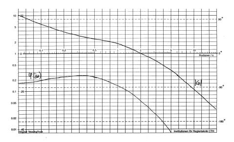
a. Bestäm den P-regulator som ger det reglerade systemet en fasmarginal av  $\varphi_m=60^\circ.$
