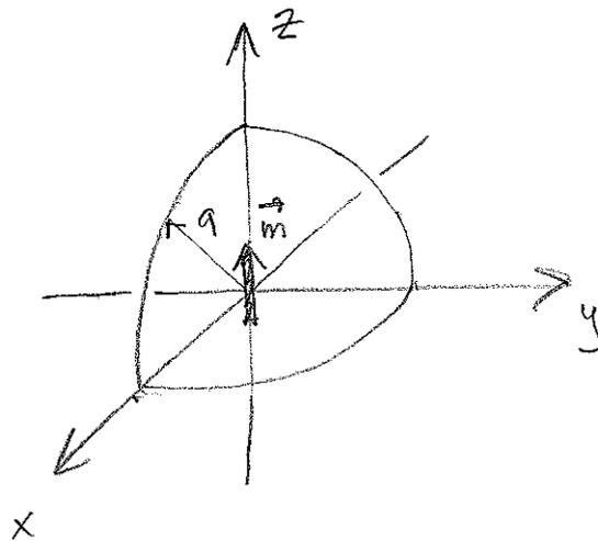
5. En slinga med resistansen  $R$  är formad enligt figuren nedan. Slingan befinner sig i ett område med den magnetiska flödestätheten  $\vec{B} = \hat{z}B_0 \cos(\omega t)$ . Beräkna den inducerade strömmen  $i(t)$  då frekvensen  $\omega$  är så låg att kvasistationära förhållanden råder. Slingans självinduktans kan försummas.
