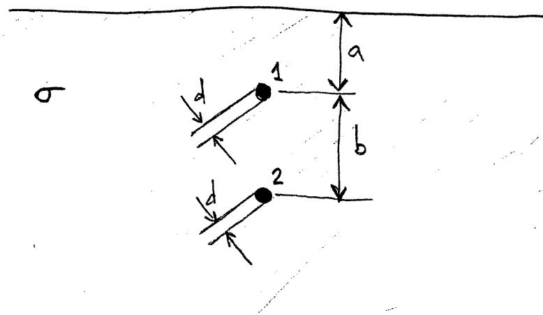
5. Beräkna inducerad spänning per längdenhet i dubbelledaren 2-3 då strömmen  $i(t) = I_0 \cos(\omega t)$  flyter i ledare 1, se figur nedan. De tre ledarna är mycket långa.
