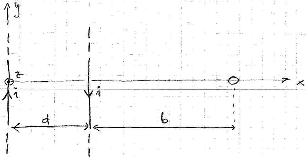
Magnetisk flödestätet från rak tråd ges av  $\vec{B} = \hat{\phi} \frac{\mu_0 i}{2\pi r}$  och med superposition för  $i$  slingans mittpunkt
